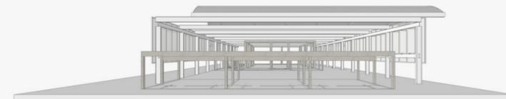
Como proceso constructivo, este sistema de estructuras independientes, permite la ejecución de toda la estructura metálica, incluyendo el techo como primera etapa y a continuación se ejecuta la estructura de hormigón, bajo la protección de la sombra y la protección del techo de chapa, lo que permite una mayor independencia de las inclemencias del tiempo, ahorrando costos operativos al emprendimiento.
